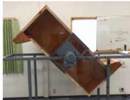
回転衝撃試験 ／試験装置内に入れた状態で一定時間回転させ、落下による損傷が発生しないかを確認します。
