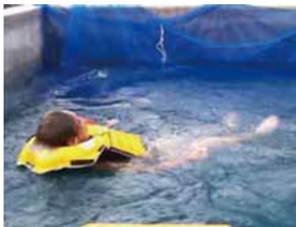
水中性能試験 ／落水した場合にも着用者が安全にかつ安定した姿勢で浮く事ができるかを確認します。
