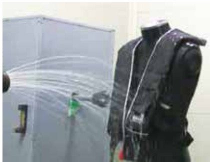
不注意膨張試験 ／水スプレーを噴霧し、降雨等による誤作動が発生しないかを確認します。
