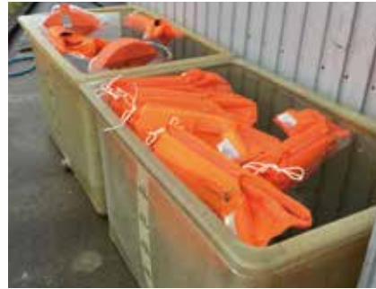
浮力試験 ／質量7.5kg(大人用の場合)の鉄片を吊り下げて浮かべた状態で24時間浮き続けられる事を確認します。
