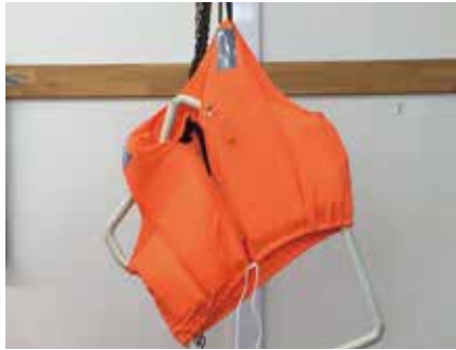
強度試験 ／横方向200kg、縦方向75kgの負荷を30分間掛けても損傷しない事を確認します。
